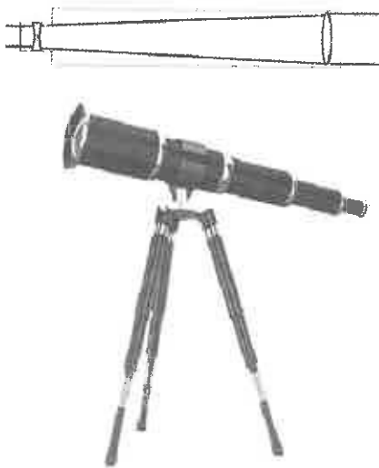
Luneta Keplera - refraktor obraz odwrócony; układ stosunkowo często
